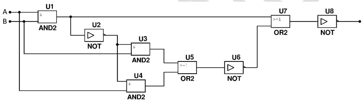
$$y(a,b) = \neg((a \wedge b) \vee \neg((\neg(a \wedge b) \wedge b) \vee (\neg(a \wedge b) \wedge a)))$$
